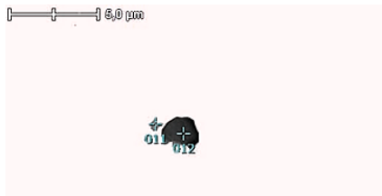
Рисунок 2 – Неметалеві включення в сталі КП-Т, яку оброблено багатофункціональними модифікаторами, х6000
