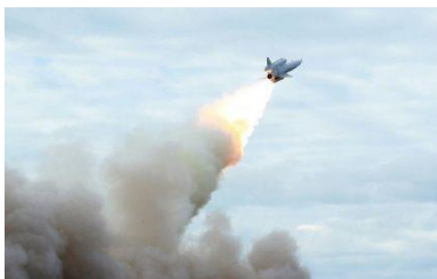
Рисунок 4 – Ту-141 «Стриж» — запуск за допомогою твердопаливного прискорювача [9]
