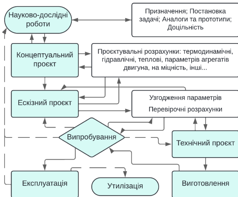
Рисунок 1 – Алгоритм проєктування ракетних двигунів (Джерело: Створено авторами)
